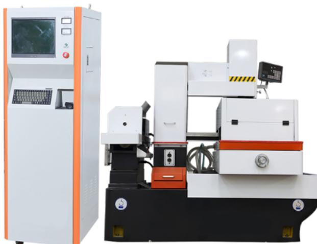
中走丝线切割半闭环伺服系统的工作原理和闭环伺服系统相似，只是位置检测器不是安装在工作台上，而是安装在伺服电动机的轴上。这种伺服系统所能达以的精度、速度和动态特性优于开环伺服系统，其复杂性和成本低于闭环伺服系统，主要用于大多数中小型数控机床。中走丝线切割机床适合加工各种复杂形状的冲模及单件齿轮、花键、尖角窄缝类零件，具有速度快、周期短等优点，应用非常普及。高速走丝的线切割机床的电极丝主要是采用钼丝，电极丝运动速度通常为8~12米/秒，而且是双向往返循环运行，在加工过程中很容易发生断丝。如果在切割工件过程中多次断丝，不仅会造成一定的经济损失，而且会带来重新绕丝的麻烦；不仅耽误时间，而且会在工件上产生断丝痕迹，影响加工质量，严重的会造成工件报废。江苏电火花中走丝线切割报价中走丝线切割的切割液很脏时，要全部换掉切割液，并清洗工切割液箱。
